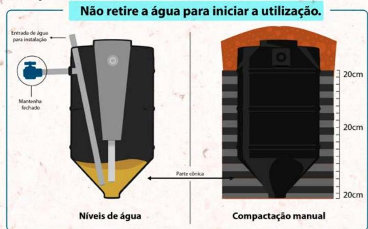
É muito importante que durante o processo de aterro, a compactação e utilização de solo peneirado sejam realizados afim de evitar que se formem vazio ao redor do BIODIGESTOR com a movimentação natural do solo, bem como evitar a presença de materiais que possam perfurar o reservatório como restos de obra, pedras, galhos e outros materiais perfurantes. Isso garantirá que o sistema fique estável e sem riscos de rompimento ou vazamentos no corpo do produto.
